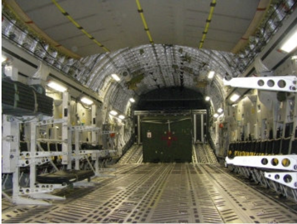
Der riesige Frachtraum des Transportflugzeugs C17: Platz für Truppen und große Lasten, die über die Heckrampe ins Innere gelangen.
