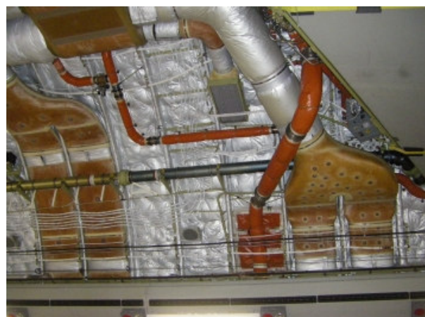
Die etwas andere Innenausstattung des Transporters aus den bevorzugten Materialien Aluminium, Stahl und Titan.
